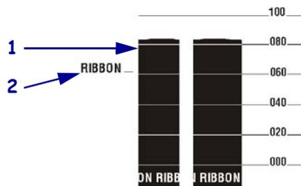
**介质传感器校正图**（图 29）介质传感器读数显示为传感器校正图上的条形和水平区域。条形 (1) 表示标签（网纹）中间的隔缝，下面的区域 (2) 表示标签所在位置。如果将传感器校正图打印输出与介质空白长度对比，介质上的隔缝应与两个条形之间的距离相同。如果距离不同，打印机可能无法确定隔缝位置。
