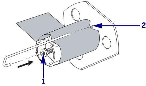
18. 将轴逆时针旋转几圈，让色带卷绕在轴钩上，并收紧松弛部分。
