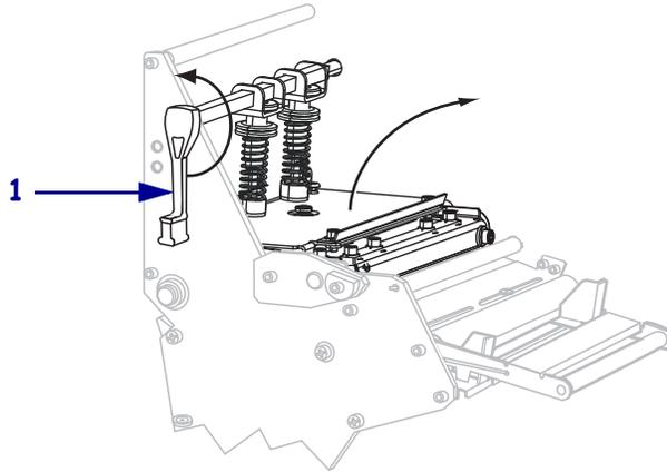
5. 松开位于外侧介质导板 (1) 底部的指拧螺钉 (无法从此角度看到)。
