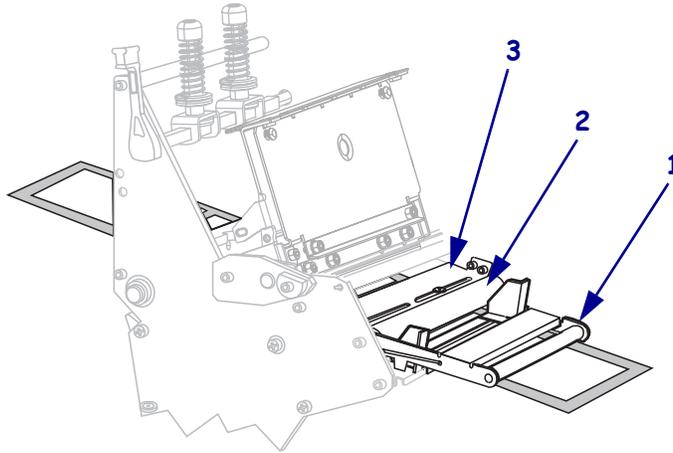
12. 将介质前推, 直到它从打印头总成 (1) 下方, 卡盘 (2) 下方和打印辊 (3) 上方穿过。
