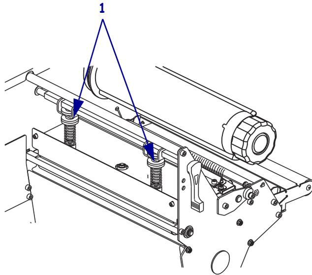
4. 某些介质类型需要更大的压力才能获得理想的打印效果。对于某些介质类型,可使用底部的压花螺母 (1) 来增大或减小压力,直到打印区域左侧及右侧边缘的颜色深度相同。
