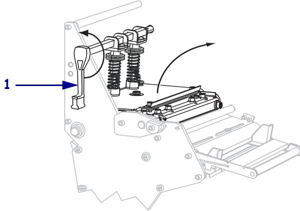
9. 松开位于外侧介质导板 (1) 底部的指拧螺钉 (无法从此角度看到)。
