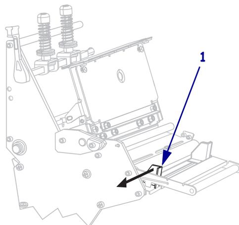
6. 如果打印机中带有介质张力调节总成 (1), 将介质从介质张力调节总成滚轮下穿过。对于所有打印机而言, 都应将介质从介质导板滚轮 (2) 和顶部介质传感器 (3) 下方穿过。
