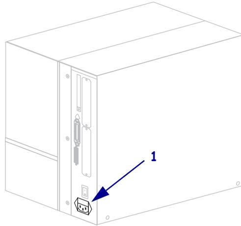
3. 将电源线的另一端插入到打印机附近的电源插座。
