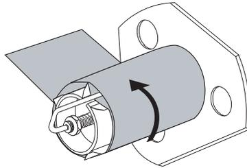
13. 将介质与内侧介质导板 (1) 对准。将外侧介质导板 (2) 推入，直到它刚好接触到介质边缘。
