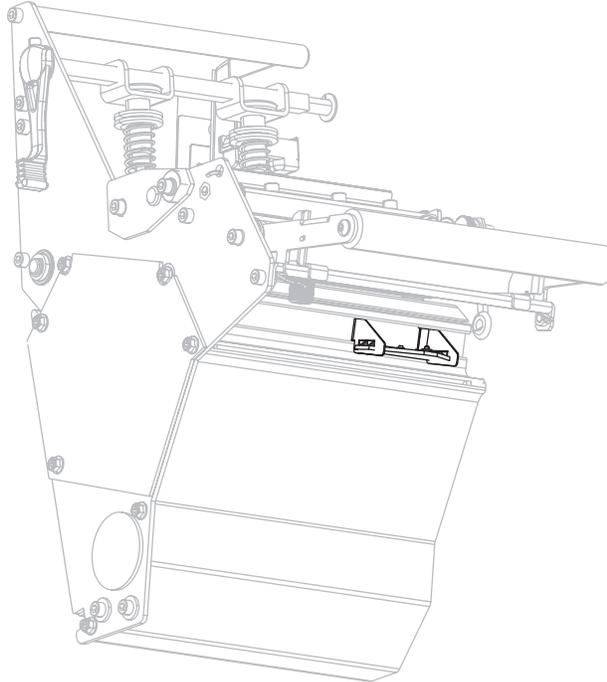
2. 滑动底部介质传感器，直到它位于顶部介质传感器的下方。使用底部传感器发出的光源帮助对准顶部传感器。可根据需要将电线轻轻拉出（电线应稍稍松弛）。
