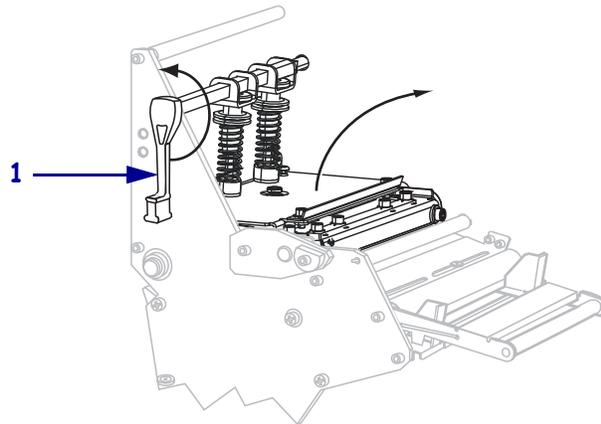
4. 松开位于外侧介质导板 (1) 底部的指拧螺钉 (无法从此角度看到)。
