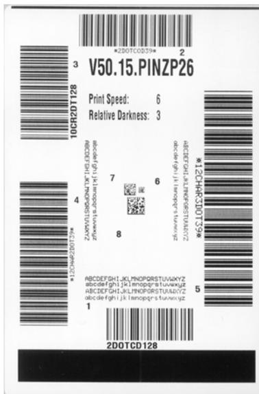
4. 请参见图 26和表 18。检查测试标签并确定哪张标签具有适合您应用的最佳打印质量。如果您具有一个条形码检验器，可以使用它测量条形 / 空白并计算打印对比度。如果您没有条形码检验器，可以使用目测方法或系统扫描仪根据在本自检中打印的标签选择最佳深度设置。
