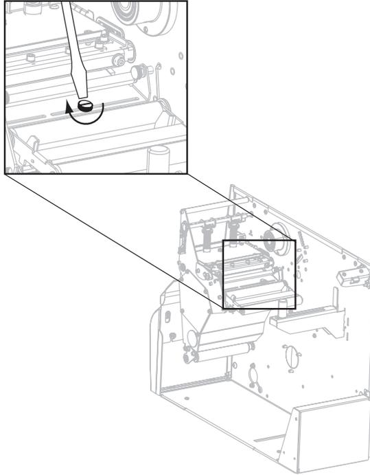
6. 根据顶部介质传感器调整后的新位置，调整底部介质传感器位置。请参见第 80 页的底部介质传感器。
