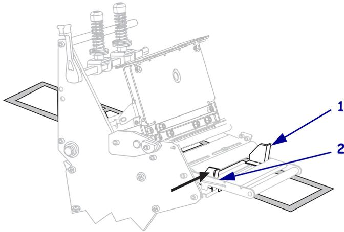
20. 拧紧位于外侧介质导板 (1) 底部的指拧螺钉 (无法从此角度看到)。
