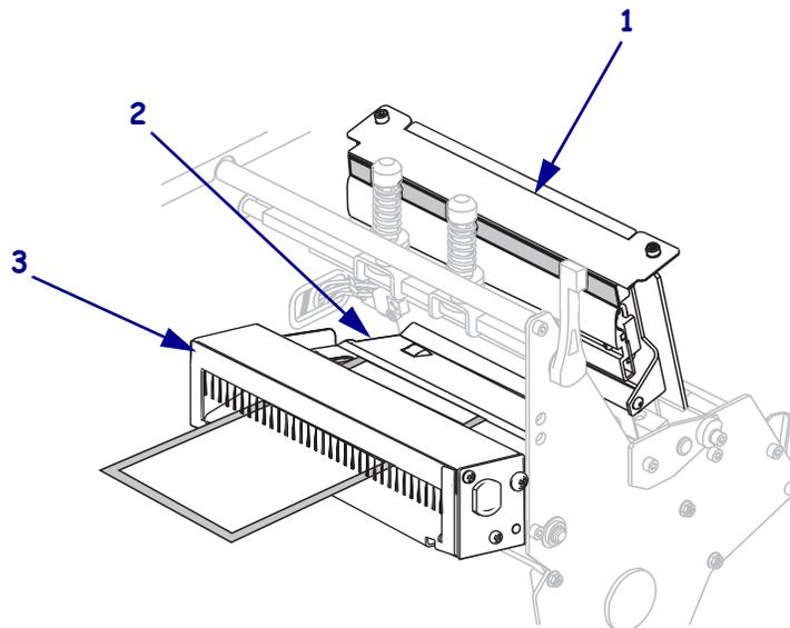
8. 将介质与内侧介质导板 (1) 对准。将外侧介质导板 (2) 推入, 直到它刚好接触到介质边缘。
