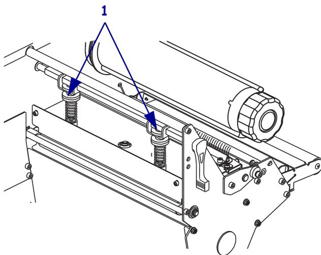
2. 滑动压紧件，直到它们在介质上施加了均匀的压力。对于非常窄的介质，应将一个压片放置在标签的中央，并减小另一个未使用压片的压力。
