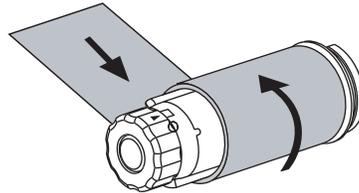
11. 将拾取轴逆时针旋转几圈，卷绕色带，以收紧松弛部分。
