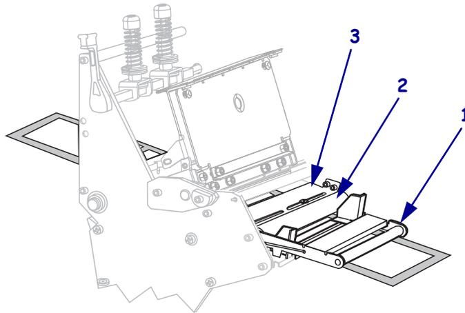
7. 将介质前推，直到它从打印头总成 (1) 下方，卡盘 (2) 下方和打印辊 (3) 上方穿过。
