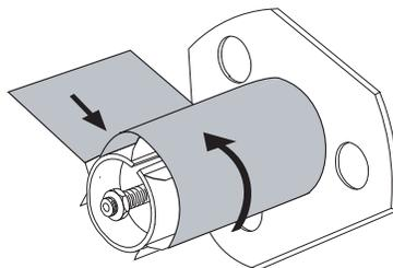
17. 重新装上轴钩。将轴钩短的一端插入调节螺母 (1) 中心的孔中。将轴钩长的一端插入导板 (2) 的小孔中。
