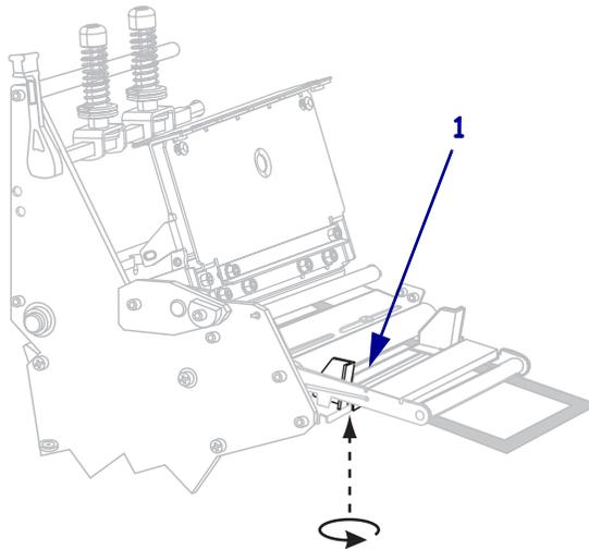
15. 将打印头总成 (1) 按下，然后顺时针旋转打印头打开杆 (2)，直到将其锁定到位。
