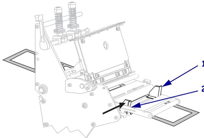
9. 拧紧位于外侧介质导板 (1) 底部的指拧螺钉 (无法从此角度看到)。
