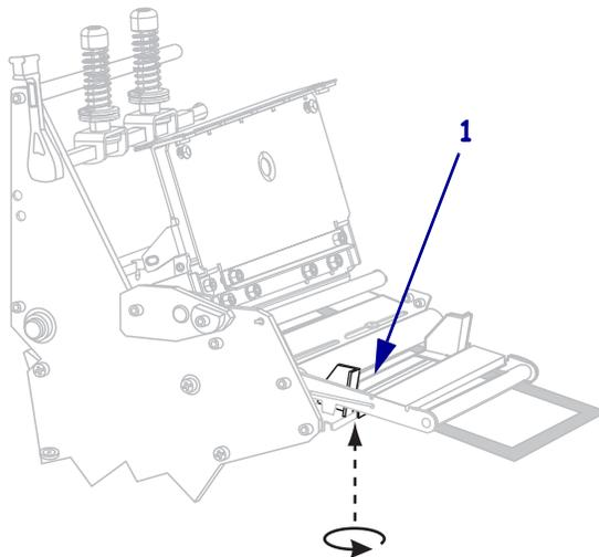
10. 将打印头总成 (1) 按下，然后顺时针旋转打印头打开杆 (2)，直到将其锁定到位。
